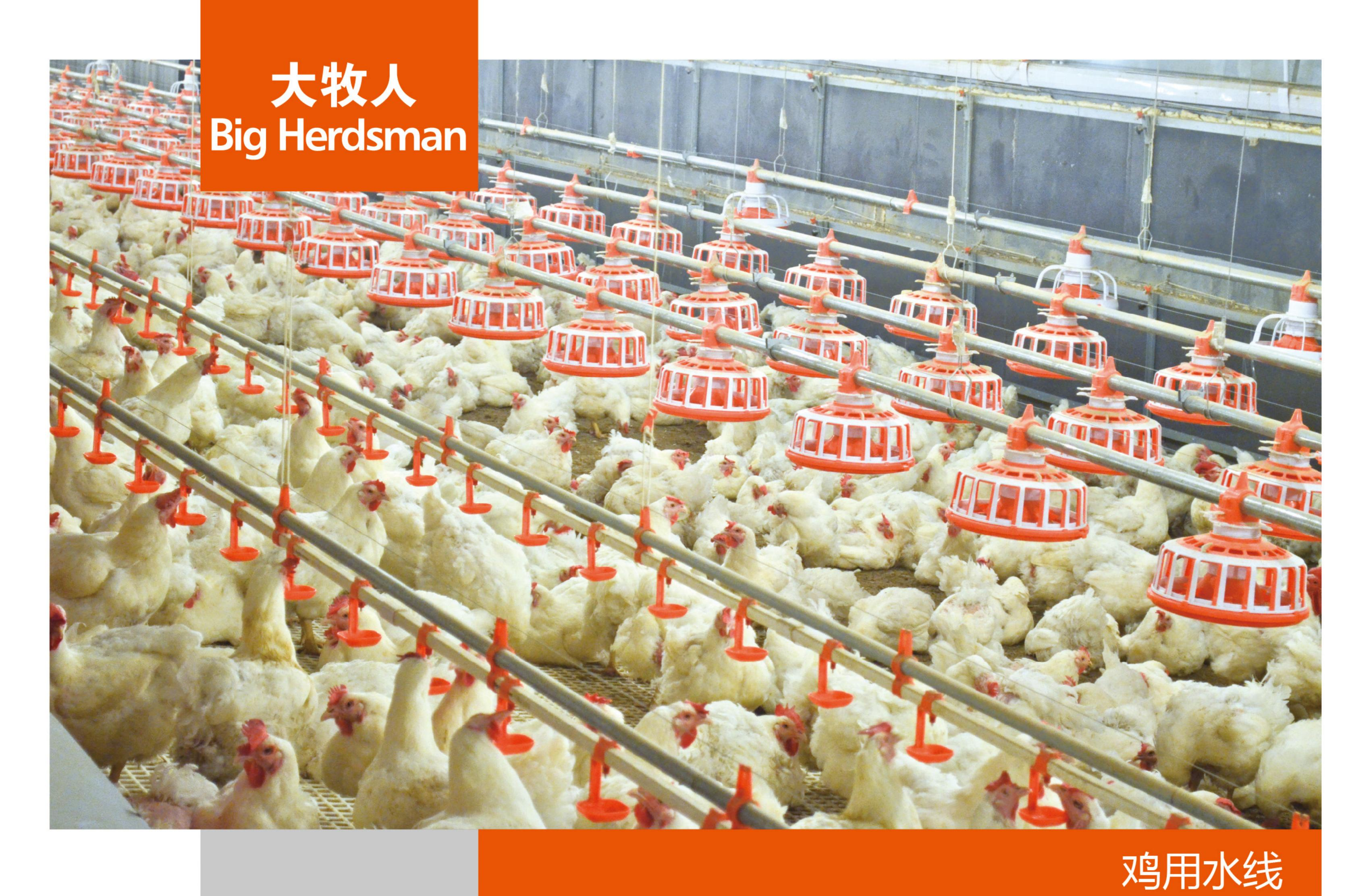
该乳头式饮水系统适用于各种禽类动物饮水,其结构简单可靠,供水及密封性能良好。
